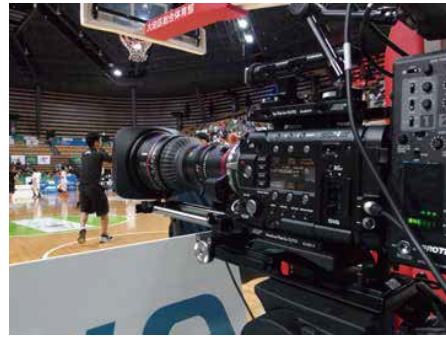
撮影にCineAlta 4KカメラPMW-F55を3台採用。スーパー35mmサイズの4K CMOSセンサー、ローリングシャッター歪みやフラッシュバンドを抑えるフレームイメージスキャン機能、トータル14ストップのラチチュードなどによる高精細な映像で好評です。しっかりした明るさを確保できる単焦点レンズ6本セットSCL-PK6/Fのほか、ズーム比7倍から20倍のズームレンズ4本も標準で装備し、幅広い4K映像表現をサポートしています。SxSメモリーカードによる本体収録、RAWレコーダーAXS-R5を接続してAXSメモリーカードによるRAW収録にも対応しています。
