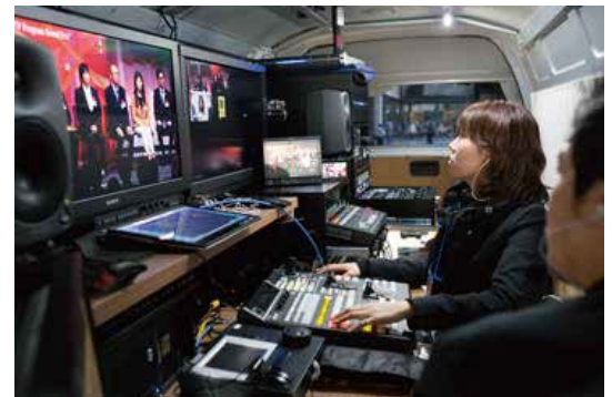
普通車両に設備搭載することや、4K運用時に1MEのコンパクトなビデオスイッチャーの搭載などにより省スペースでの運用を実現。また、機器一式を可搬型ラックに組み込んだことで車内だけでなく、車外でのスピーディーな設営・運用・撤収が可能になっています。そして、同社4Kプロジェクトチームの撮影・制作スタッフによるオペレーションチームが撮影環境に柔軟に対応するだけでなく、コンパクトな4K中継・映像制作サービスの実現でコストの低減にも貢献します。4K運用時には3G/HD-SDIのケーブル4本を配備しなければならない点も、要所所に4心同軸DINマルチコネクタを配備することで効率的な運用とスタッフのストレス低減に貢献しています。
