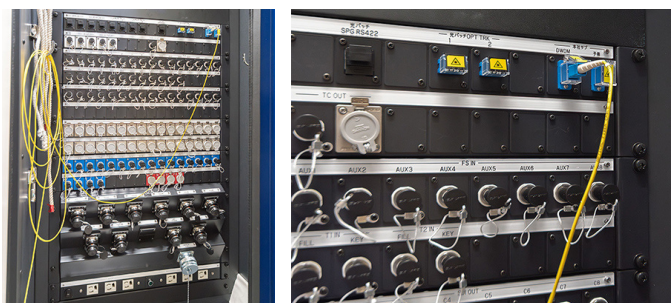
中継車背面のジープ盤、黄色い光ケーブル1本で本社と全てを接続できる
