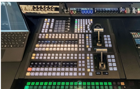
2M/E・12XPTボタンのラックマウントサイズの一体型パネルを採用
