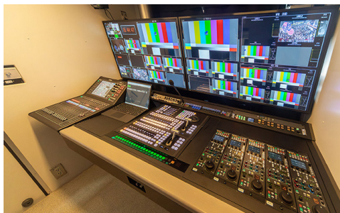
中継車のスイッチャー卓、ワンマンオペレーションに対応できる配置が特徴
