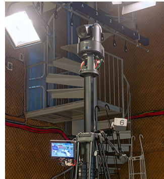
電動のベDESTAL付き三脚を介して、制作スタジオ内の高所に据えられた『BRC-AM7』
