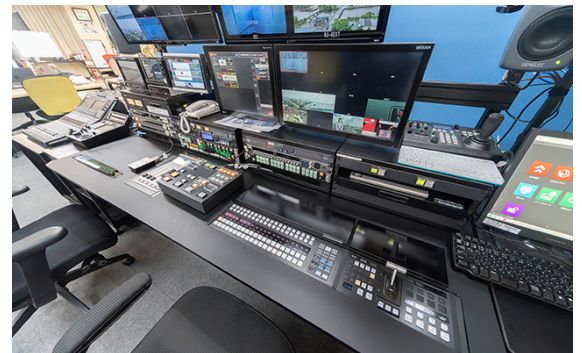
報道サブはソニー製OTCシステムで運行され、通常『MLS-X1』のパネルには誤操作防止カバーがかけられる
